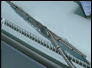
**Limpiaparabrisas con boquillas de lavado integradas**
