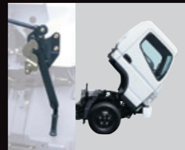
**Palanca de inclinación de la cabina por el lado del pasajero**
